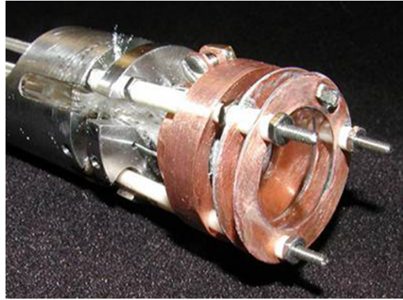
(d) Ion source assembly.
